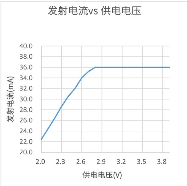
图 4-3 发射电流 vs 供电电压
