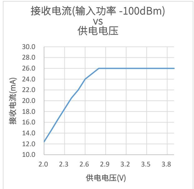
图 4-4 输出功率(输入功率-100dBm) vs 供电电压
