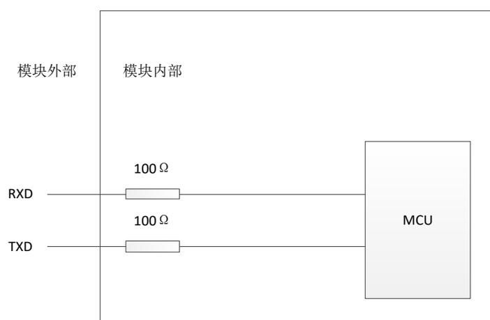
图 5-4 RXD、TXD 引脚内部结构示意图
